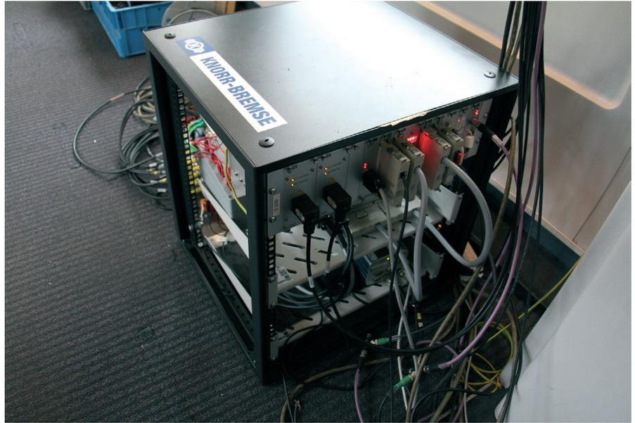
**Bild 4:** Eine zusätzliche, parallel zur originalen Bremssteuerungs-Hardware eingebaute Elektronik dient der Implementierung der neuen Funktionen und Algorithmen.
