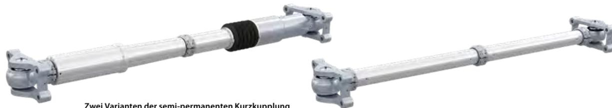
Zwei Varianten der semi-permanenten Kurzkupplung **„SHORTLINK“** verbinden die Wagen innerhalb des Zugverbandes miteinander.
