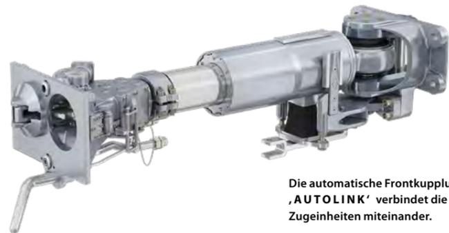
Die automatische Frontkupplung **„AUTOLINK“** verbindet die Zügeinheiten miteinander.
