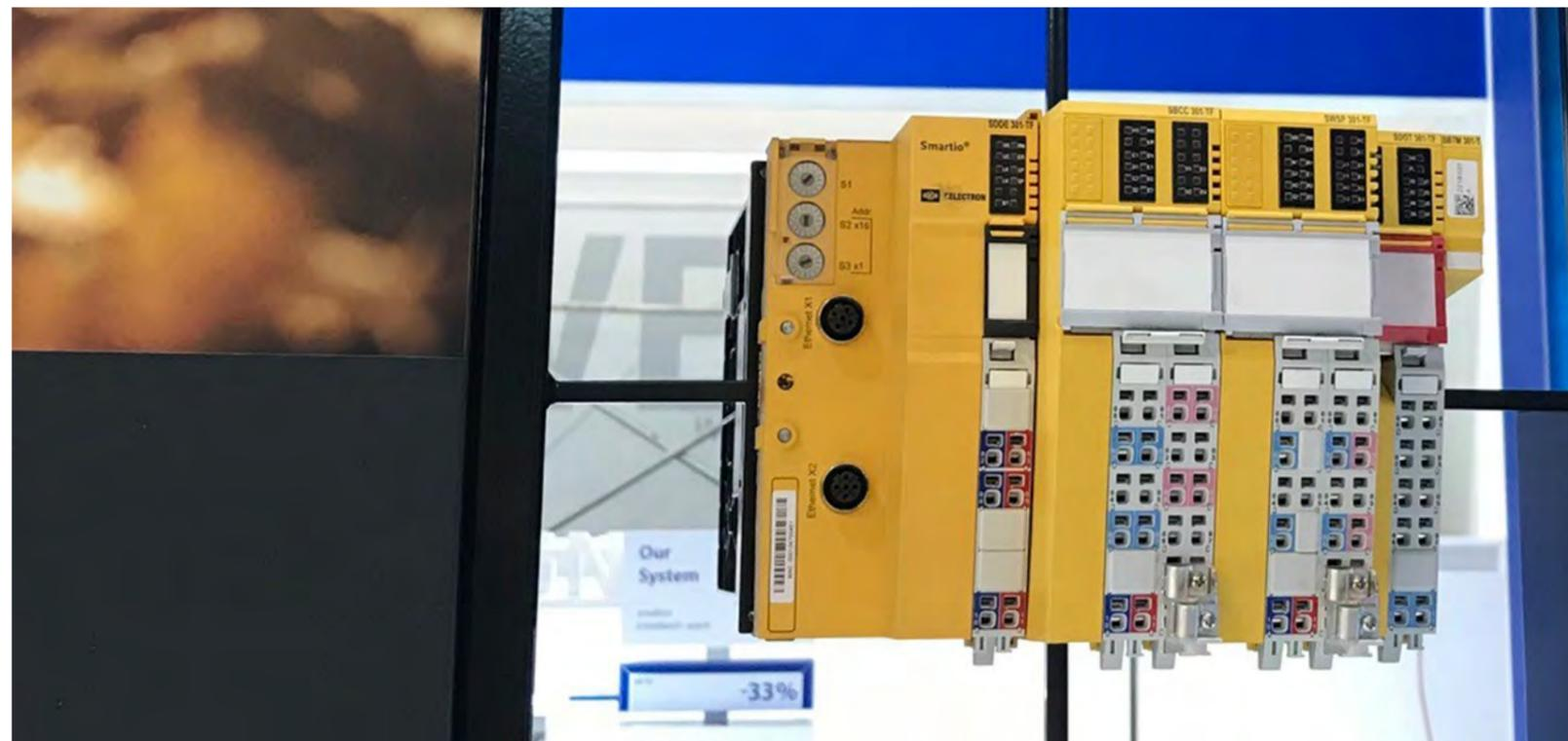
Dutzende Funktionalitäten wollen beim Neubau von Fahrzeugen geschickt integriert werden. TSI-Gleitschutz, Vorsteuerdruckregler und Zählereingangsmodule zum Beispiel. Doch naturgemäß ist der Platz für derartige Hardware im Fahrzeug stark beschränkt. Deshalb hat die Selectron Systems AG, der Spezialist im Knorr-Bremse Konzern für Steuerungs-, Netzwerk- und Kommunikationstechnologie, die drei Funktionalitäten nun in ihr Smartio® Portfolio integriert.
