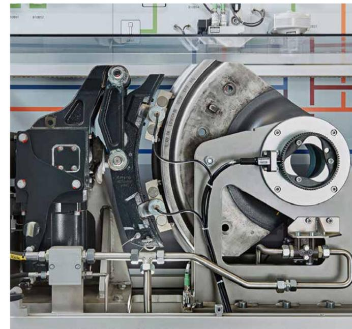
KLOTZBREMS-EINHEIT und Gleitschutz am CT<sup>2</sup>
