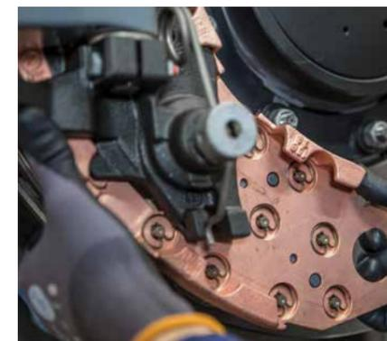
EINBAU eines UltraPad Extreme Sinterbelags für anspruchsvollste Bremsanwendungen
