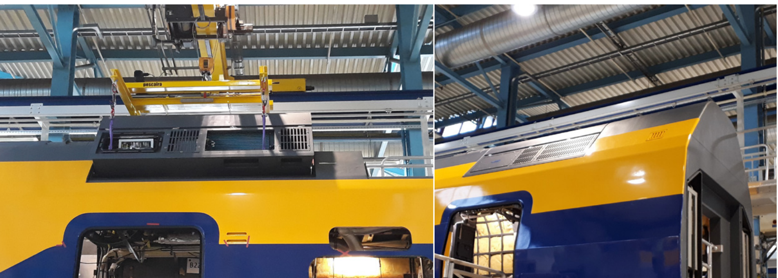
▲ Insgesamt tauscht Knorr-Bremse 484 in den 1990er Jahren verbaute Einheiten gegen energieeffiziente Klimasysteme aus.
