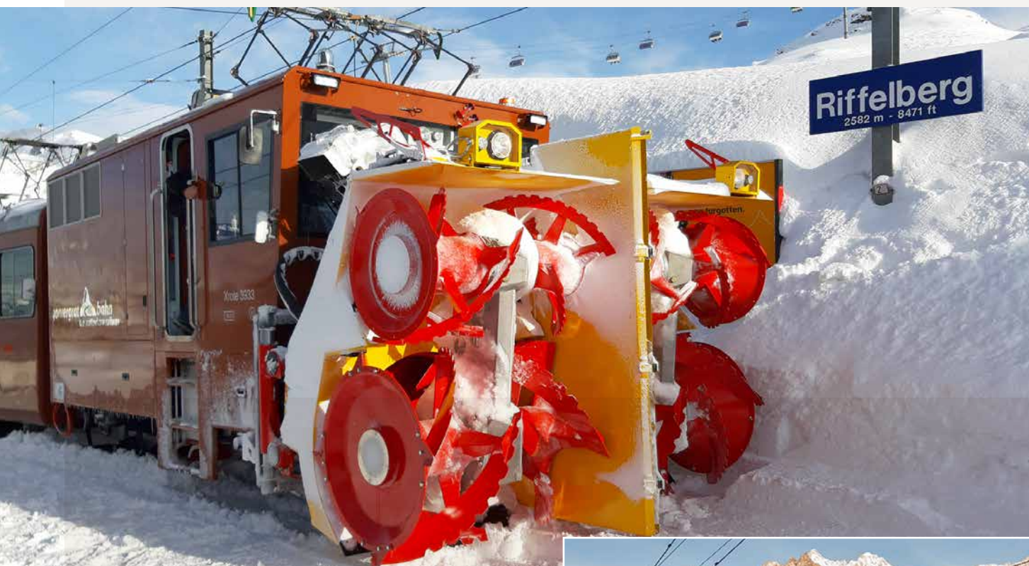
▲ „Xrote 3933“, die Schneefrässschleuder der Gornergrat Bahn
