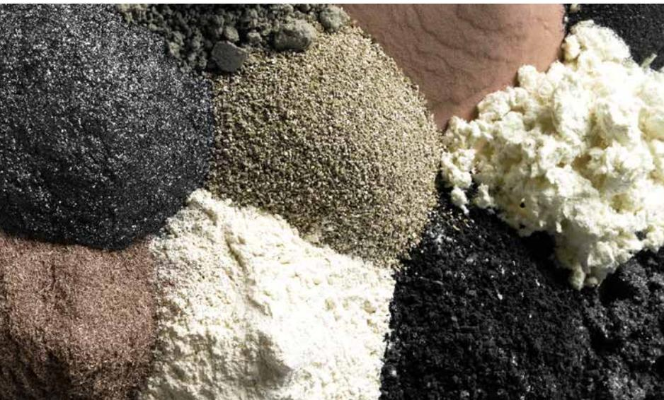
▲ Pulver zur Entwicklung der optimalen Reibmaterial-Kombination
