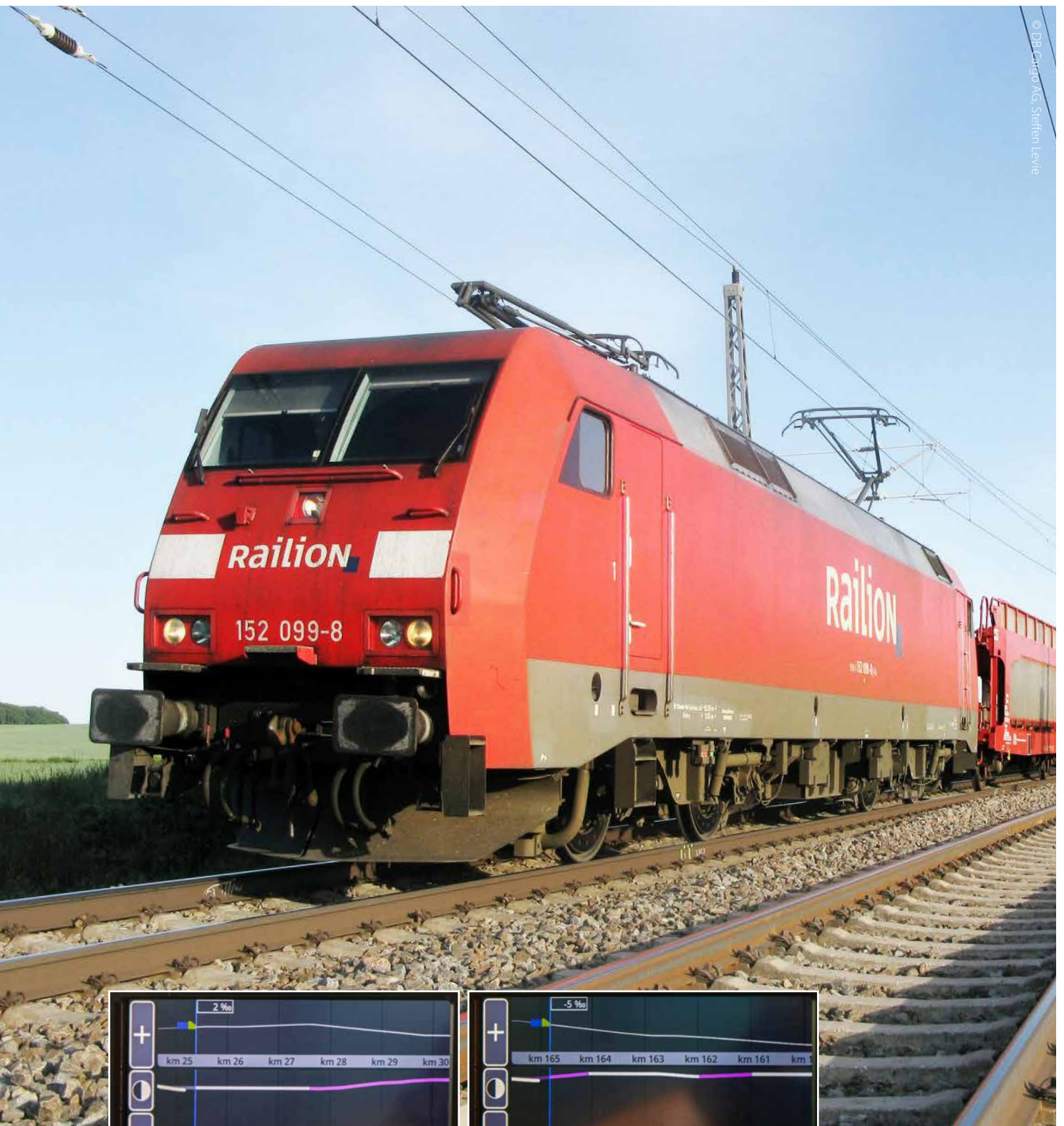
Benutzeroberfläche des Fahrassistenzsystems LEADER DB Cargo in der Lok
