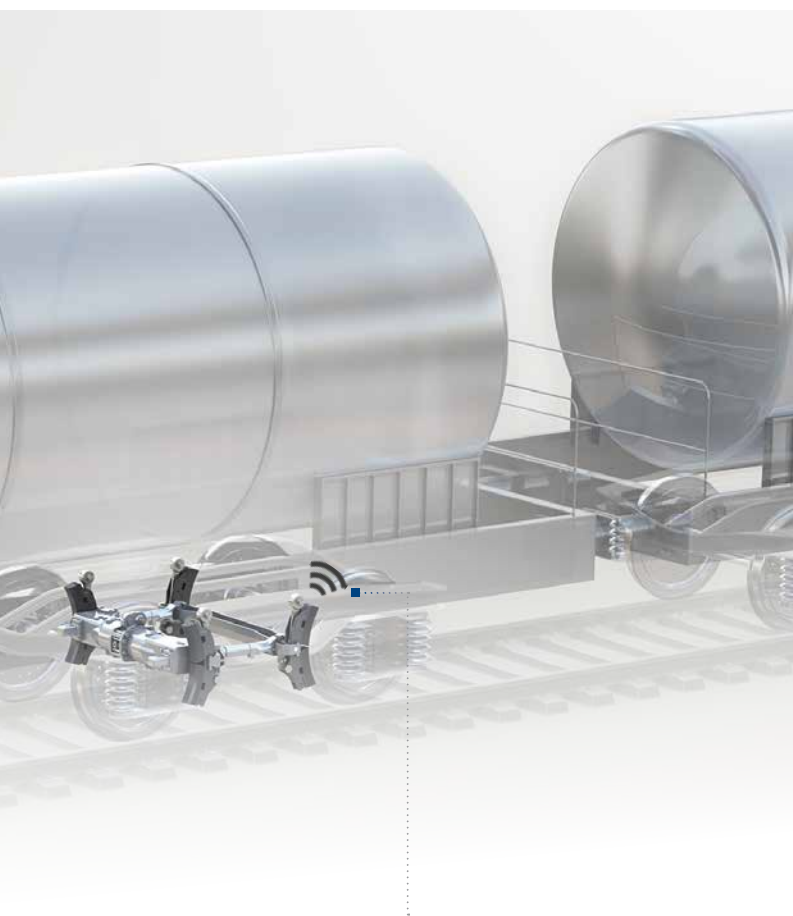
Sensoren an Drehgestell und Wagenaufbau zur Wagen- und Gleisüberwachung
