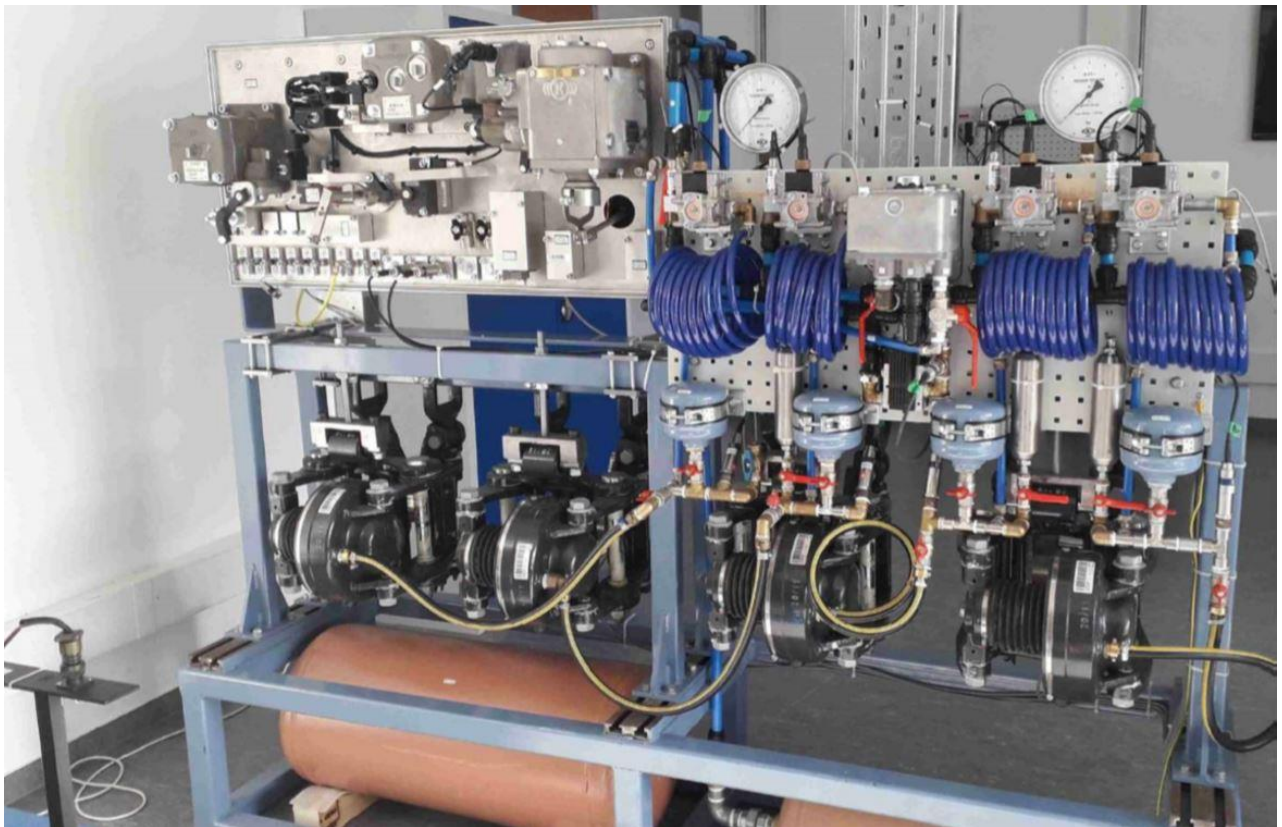
Abbildung 2: Gleitschutz-Systemprüfstand zur Optimierung von Gleitschutzanlagen Fahrversuche - Um etwa zehn Prozent verkürzte Bremswege
