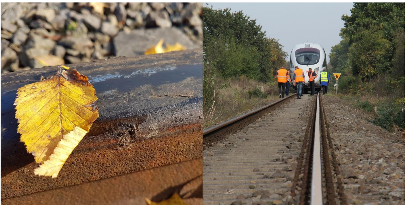
Bild 3: Der hergestellte „Black Leaf Layer“ aus aufgebrachtem Laub (l.) bzw. Papier (r.) bildete realistische Umweltbedingungen für die Versuchsfahrten
