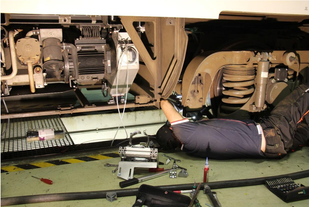
Bild 2: Installation der dynamisch ansteuerbaren Sandungsanlage vor dem dritten Radsatz des Versuchsträgers
