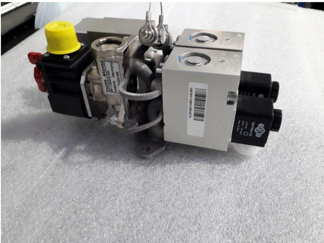
*Abb. 4: Für einen direkten Vergleich durchlief der 3D-gedruckte Funktionsträger sämtliche auch bei konventionell gefertigten Tafeln gängige Funktionstestsequenzen. Die Werte stellten sich als nahezu deckungsgleich heraus.*
