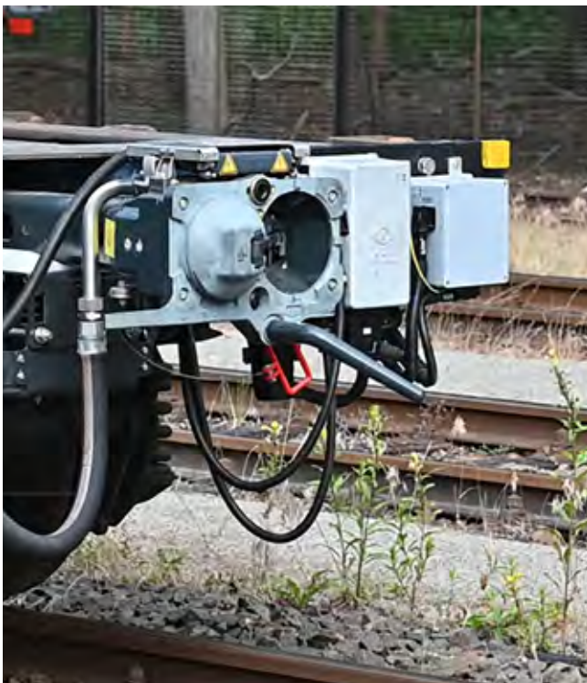
Train Test Laboratory in Berlin-Spandau: Erste ferngesteuerte Entkupplung im Zugverband
