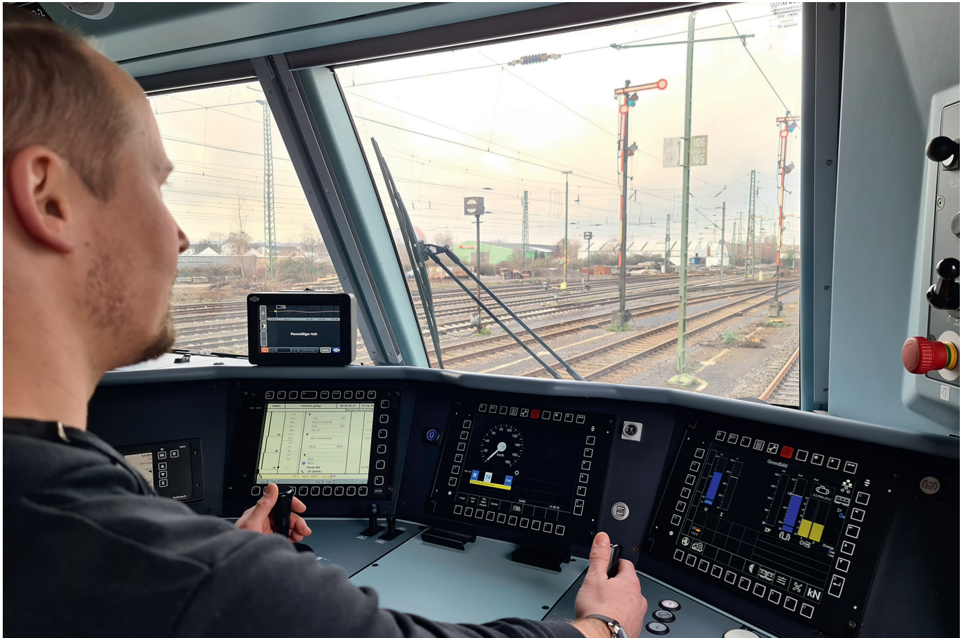
Aus den Echt-Daten des FAS LEADER bei DB Cargo lassen sich belastbare Aussagen zur erzielbaren Energieeinsparung interessierter EVU ableiten. Quelle aller Abb.: DB Cargo AG
